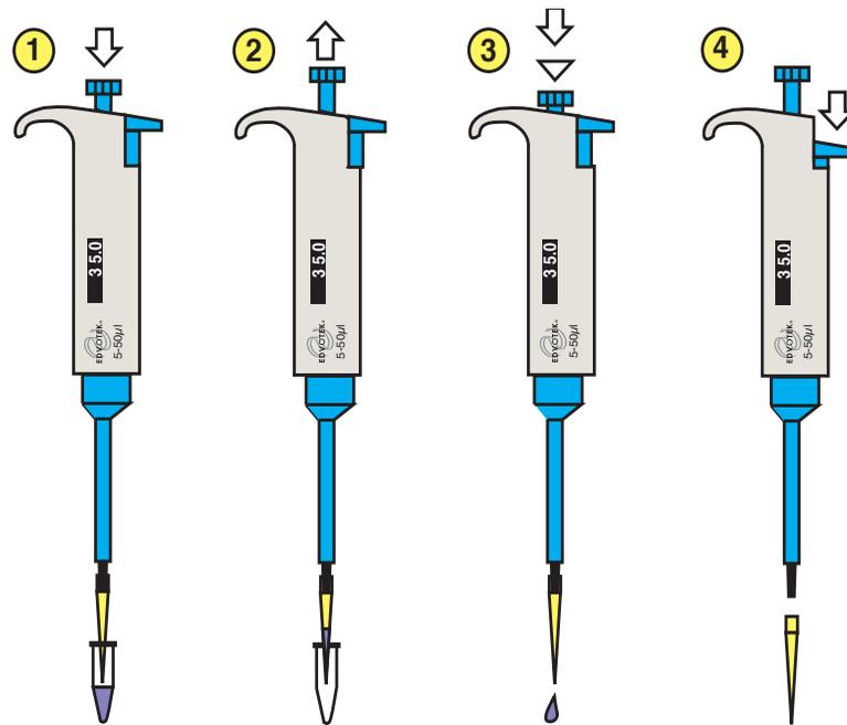
**SAMPLE DELIVERY WITH VARIABLE AUTOMATIC MICROPIPETETS**
